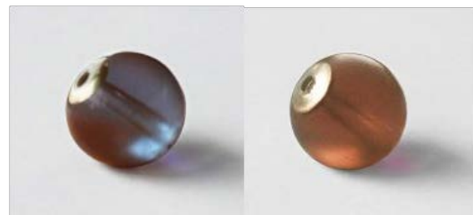
Los colores de estas cuentas fueron producidos mediante la desintegración de nanopartículas de oro y plata. Los colores son exclusivos a estas cuentas en particular.
