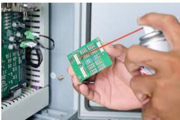
技术人员可以利用化学喷雾法清除重要电子元件上的暗色银物质。
