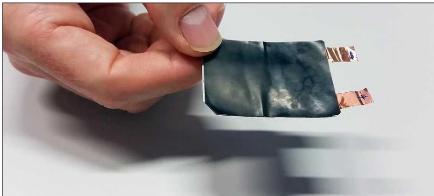
Las escamas de plata permiten que esta batería sea flexible.
