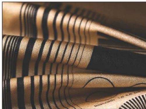
采用纳米银和硅脂材料制成的可伸缩传感器可以带来更高弹性，并且能够进行大规模生产。
