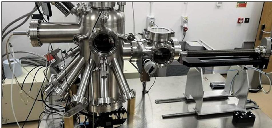
Con esta máquina nueva llamada “Matrix Assembly Cluster Source” (MACS), se produce un compuesto catalizador de átomos de plata.
